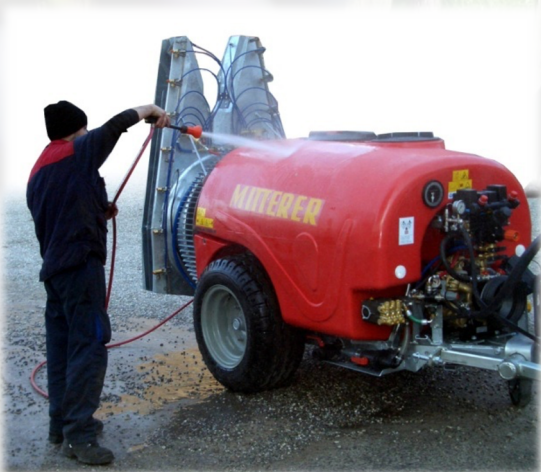
Lavaggio esterno tramite sistema indipendente a lancia
